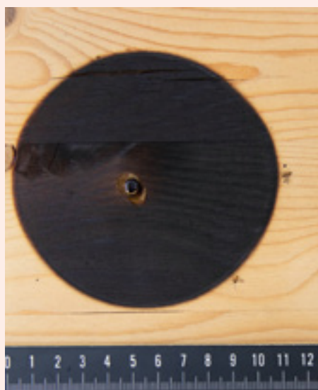
Figur 7 Figuren viser spor etter en fakkelboks som har overtent.
