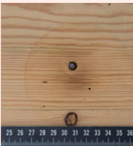
Figur 8 Figurene viser typiske spor etter fakkelbokser som ikke har overtent.
