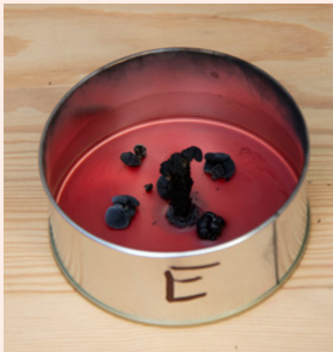
Figur 4 Overtenning skjer som følge av at veken deler seg opp i mindre biter. Dersom disse brenner vil boksen kunne bli så varm at all voksen antenner.
